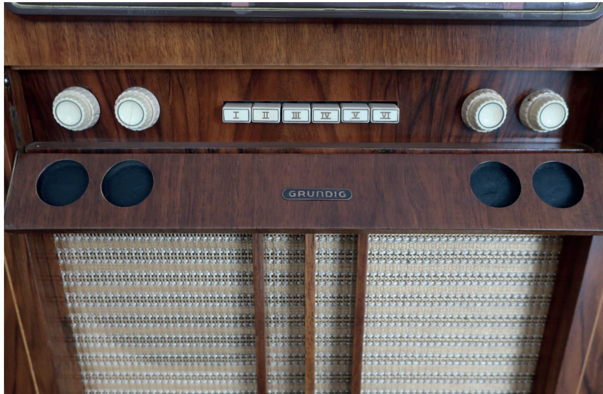
Abb. 3: Die Drucktasten für die Kanalschaltung sowie die Einstellregler (Doppelpotis) z.B. für Kontrast, Helligkeit, Lautstärke, Klang, Bildfrequenz fein und Zeilenfrequenz fein waren hinter einer Frontklappe verborgen. (Foto M2Counselling mit Genehmigung des Rundfunkmuseums der Stadt Fürth)
