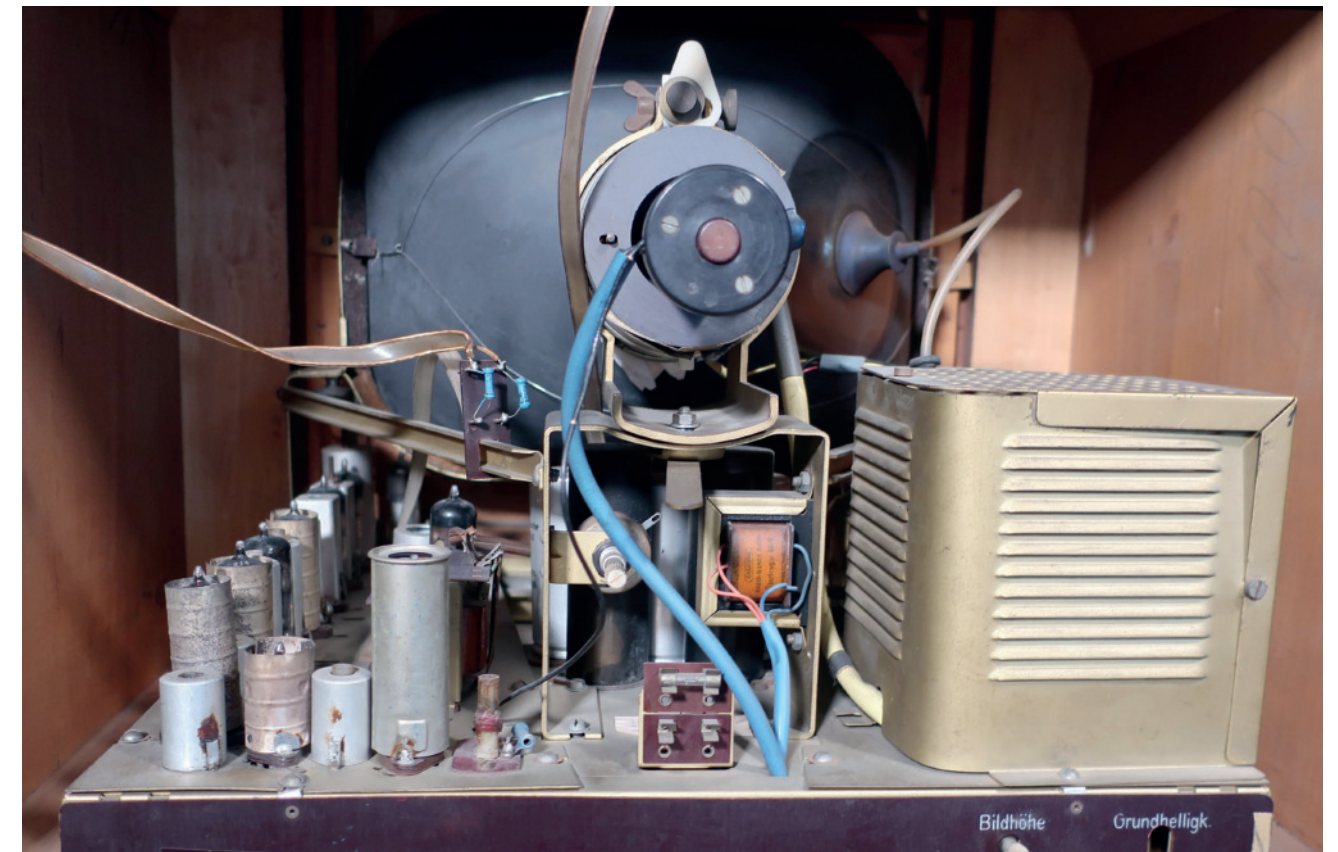
Abb. 4: Erstes Fernsehgerät von Grundig, der Geräte-Typ 080. Geräteansicht von hinten. (Foto M2Counselling mit Genehmigung des Rundfunkmuseums der Stadt Fürth)
