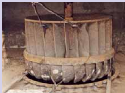
Die alte Schneider-Schaquet-Turbine (mi) trieb ursprünglich über ein Kammradgetriebe (li) und weiter über einen Riemenantrieb (re) die Mühle an. Der Umbau erfolgte 1992.
