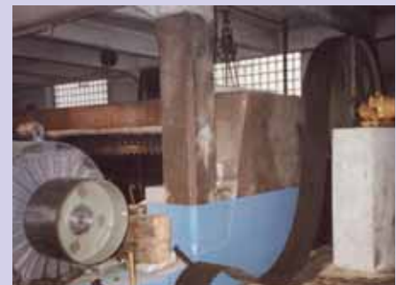
Die alte Schneider-Schaquet-Turbine (mi) trieb ursprünglich über ein Kammradgetriebe (li) und weiter über einen Riemenantrieb (re) die Mühle an. Der Umbau erfolgte 1992.
