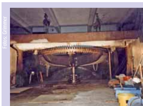
Die alte Schneider-Schaquet-Turbine (mi) trieb ursprünglich über ein Kammradgetriebe (li) und weiter über einen Riemenantrieb (re) die Mühle an. Der Umbau erfolgte 1992.
