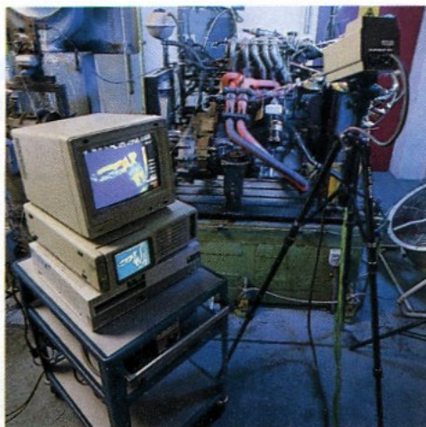
Motorenprüfstand mit neuester Technik „Thermokamera“
