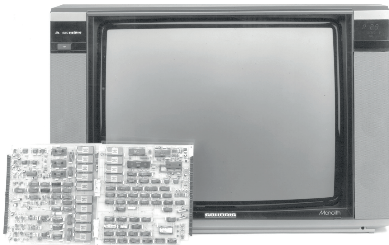
ABB. 1: Der Grundig Monolith 70-390/7 Text, das erste 100 Hz TV-Seriengerät.
