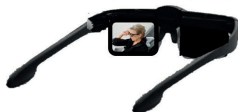
Abb. 1: Das Shutterbrillenverfahren. Die Brille lässt für das linke und das rechte Auge nur das zugehörige Kamerabild passieren.
